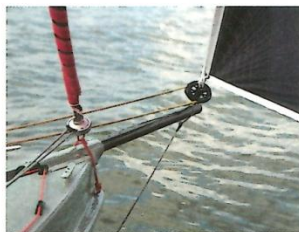
Der flache Gennaker wird am ausfahrbaren Bugspriet gesetzt, die Spiere aus Kohlefaser ist optional
