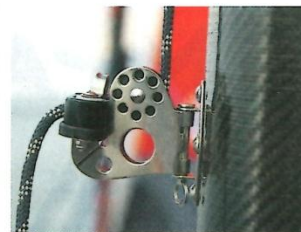
Alle Fallen werden direkt am Mast bedient, das geschieht trotzdem einfach und bequem aus der Plicht
