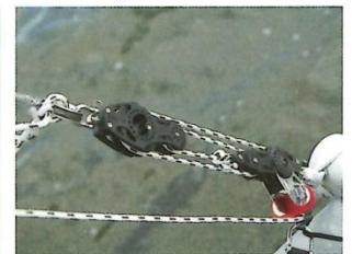
Die gut unteretzten Backstagen an den Schwimmern gehören zum Sportpaket, sind aber immer sinnvoll
