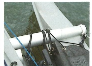
Bevor die Schwimmer eingeschoben werden können, muss das Trampolin etwas gelöst werden
